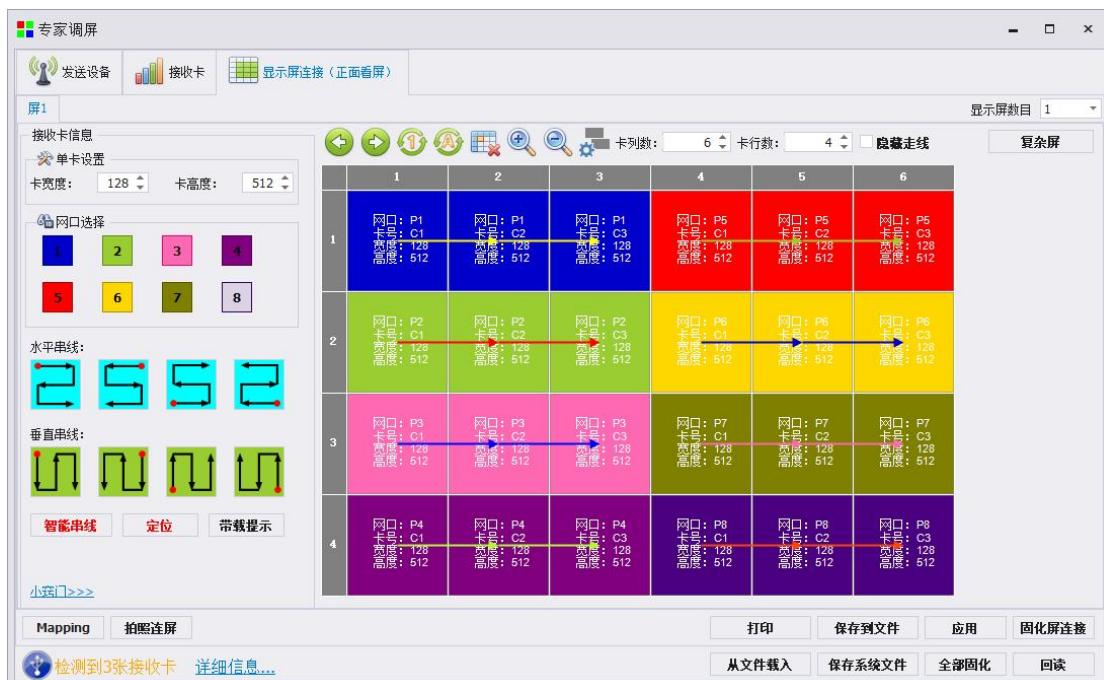
参数设置完成后，大屏显示正常，点击“全部固化”即可。
