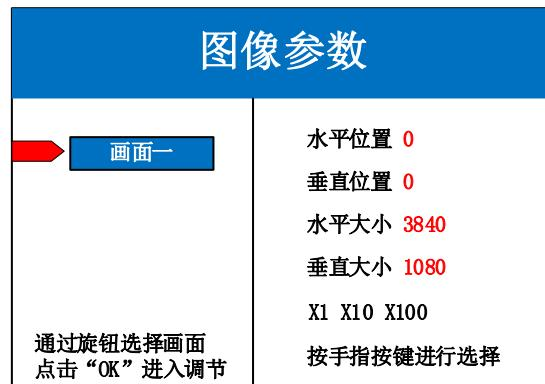
**第四步：**点击“MENU”，返回主菜单界面，进入菜单——高级——常用功能——局部显示（或使用前面板 FUNC 按键可快速进入常用功能，选择局部设置），进入局部显示设置界面，设置每个信号源的局部截取的大小以及位置。
